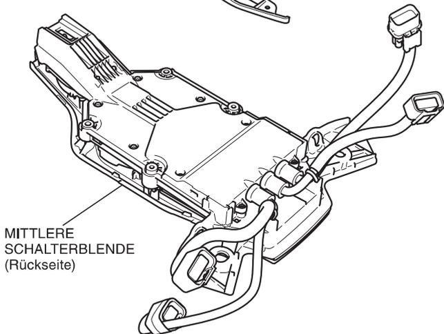
34. Entfernen Sie die Mittelkonsolenblende, wie in der Abbildung dargestellt.
