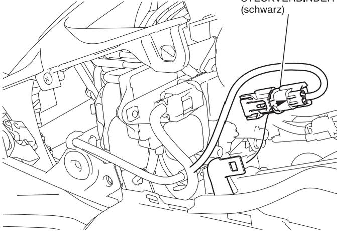
18. Entfernen Sie den Sicherungsring und trennen Sie den Steckverbinder wie in der Abbildung dargestellt.
