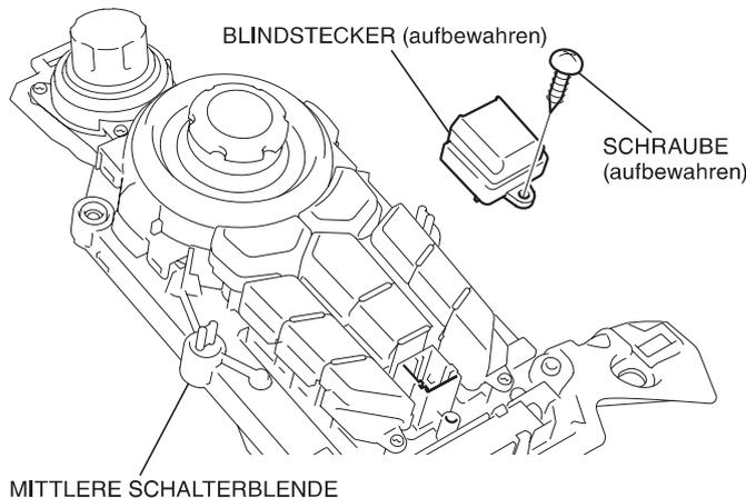
36. Montieren Sie den Nebelscheinwerferschalter, wie in der Abbildung dargestellt.
