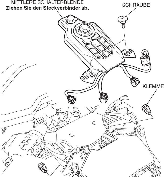
33. Entfernen Sie die rechte und linke Mittelkonsolenverkleidung, wie in der Abbildung dargestellt.
