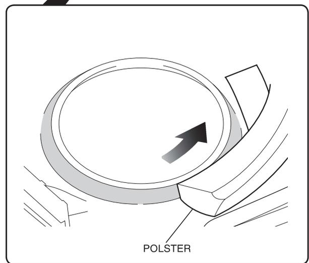
31. Befestigen Sie den Dämpfer an der rechten Nebelscheinwerferabdeckung auf die gleiche Weise wie auf der linken Seite.
