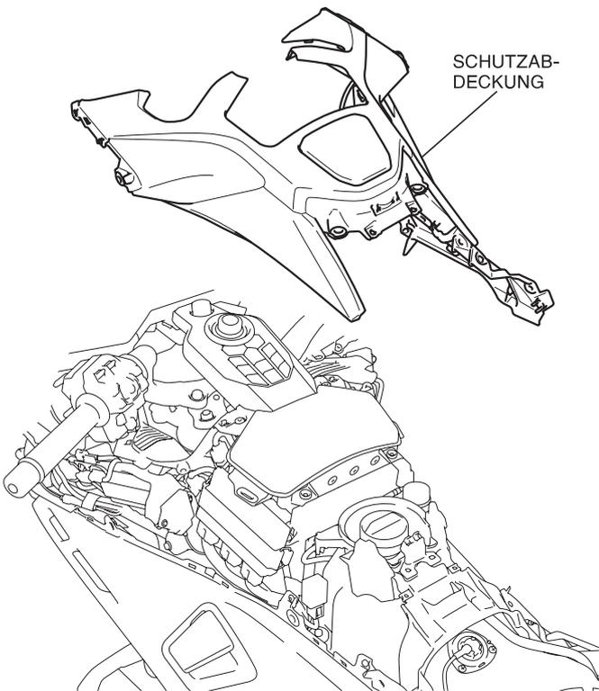
23. Entfernen Sie die linke Nebelscheinwerferabdeckung, wie in der Abbildung dargestellt.
