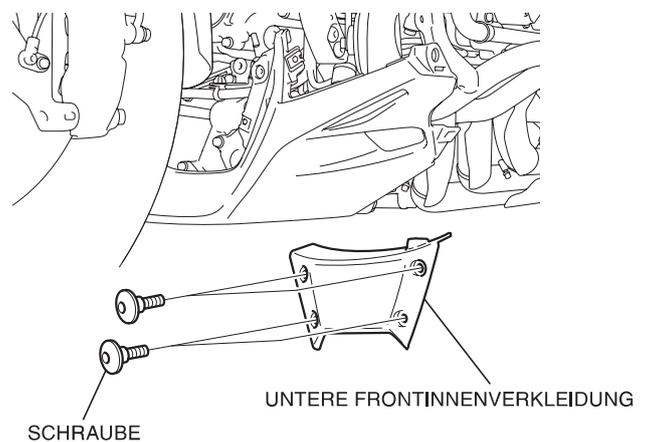
27. Entfernen Sie die untere Frontverkleidung gemäß Abbildung.
