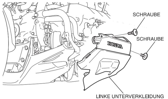
25. Entfernen Sie die rechte Nebelscheinwerferabdeckung und die rechte Unterverkleidung in der gleichen Weise wie auf der linken Seite.
