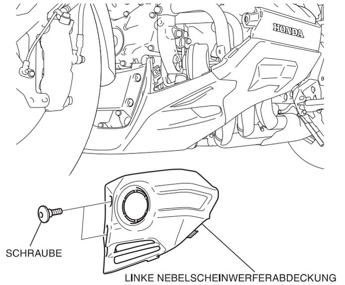
24. Entfernen Sie die linke Unterverkleidung, wie in der Abbildung dargestellt.
