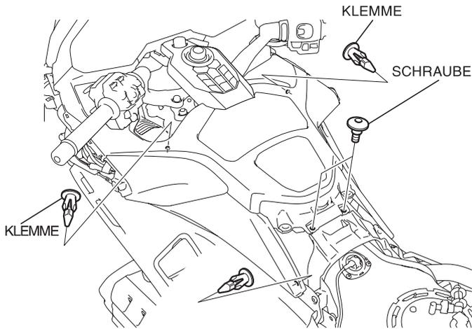
22. Entfernen Sie die Schutzabdeckung, wie in der Abbildung dargestellt.
